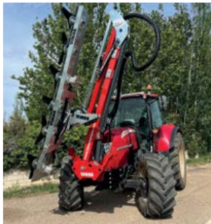
De izqda. a dcha., prepodadora PVF20 con cinco discos de corte; prepodadora PVF20 con seis cuchillas triple aspiradora; y prepodadora PVF20 con corte de doble cuchilla.
