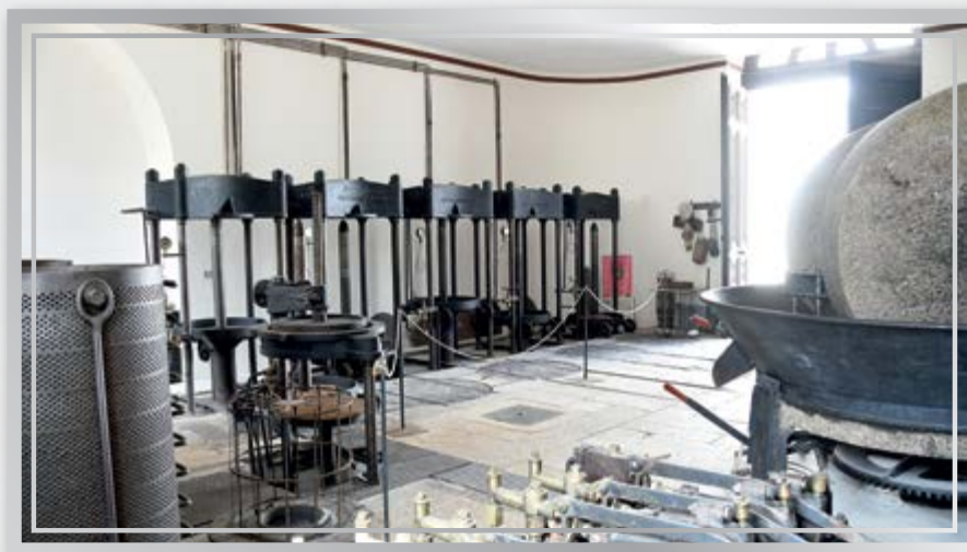
Figura 2. Almazara de la finca Terre di Traiano : dos molinos con dos piedras, prensas hidráulicas con cuatro columnas, a torre abierta y bomba. Andria (BT). Fotografía de Antonio Monte, 2017.
